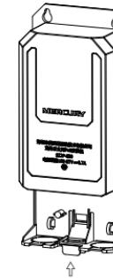
⑤ 通过壁挂孔将交换机安装在合适位置。
